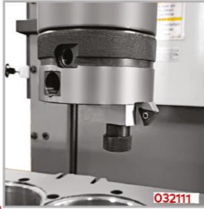
Havşa kalemi, silindir ağızına havşa açmanızı sağlar. Chamfering a cylinder with the chamfering tool.
