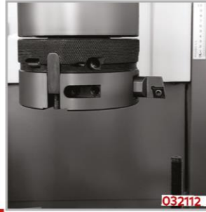
Silindiri merkezledikten sonra, rektefiye edebilirsiniz After centring the cylinder, you can bore the inside of cylinder.
