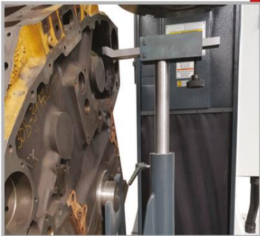
Seri sıkma aparatı, motor bloklarını daha kuvvetli sabitlemek için kullanılır(Opsiyonel ekipmandır) Pair of quick setting up fixture, help to place engine blocks faster and stronger on machine work table
