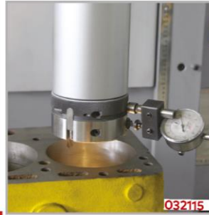
Paso verme aparatı, işleyeceğiniz çapı ayarlayıp talaş (paso) vere- bilirsiniz. Tools setting device (without dial gauge) Adjusting the diameter you may boring the engine block.
