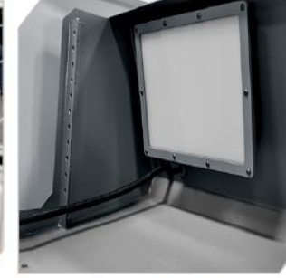
Taşın işe yaklaşma led aydınlatması Whell flat surface approaching led light.
