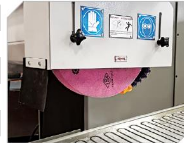
Ayarlanabilir taş muhafazası Configurable grinding wheel cover
